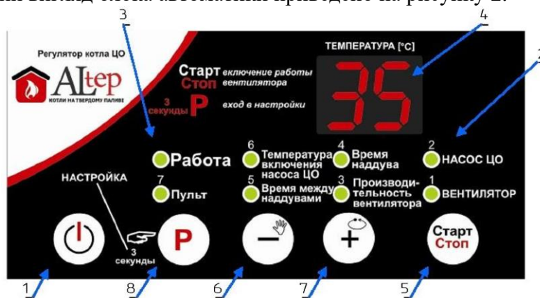
Рисунок 2 – Зовнішній вигляд передньої панелі контролера
